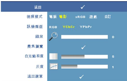
**視頻模式** — 根據投影機使用的方式，選取一個使顯示影像最佳化的模式：**電腦**、**電影**、**sRGB** (提供更精準的色彩呈現)、**遊戲** 以及 **自訂** (可依您的喜好來設定)。如果您調整**白光飽和度**或**灰度**，投影機會自動切換至**自訂**模式。
