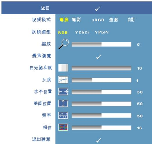
**視頻模式** — 根據投影機使用的方式，選取一個使顯示影像最佳化的模式：**電腦**、**電影**、**sRGB**（提供更精準的色彩呈現）、**遊戲**以及**自訂**（可依您的喜好來設定）。如果您調整**白光飽和度**或**灰度**，投影機會自動切換至**自訂**模式。
