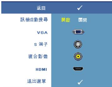
**訊號自動搜尋**—選擇**開啓**（預設），自動偵測可使用的輸入訊號，選擇**開啓**後並按下控制面板/遙控器上的「輸入源」，投影機將自動尋找下一個可用的輸入信號。選擇**關閉**以鎖定目前輸入信號，或手動選擇您欲使用的輸入信號。當選擇**關閉**並按下「輸入源」時，就可選取想使用的輸入訊號。
