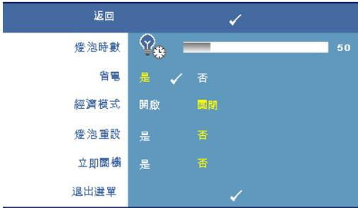
**燈泡時數** —顯示從燈泡計時器重新設定後開始運作的時數。
